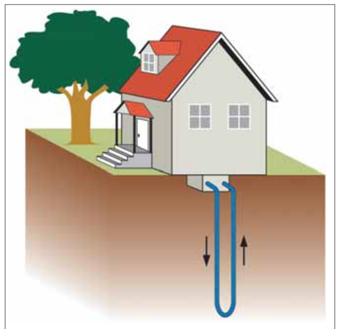
Schema einer Erdwärmesonde Quelle: Geologischer Dienst NRW
