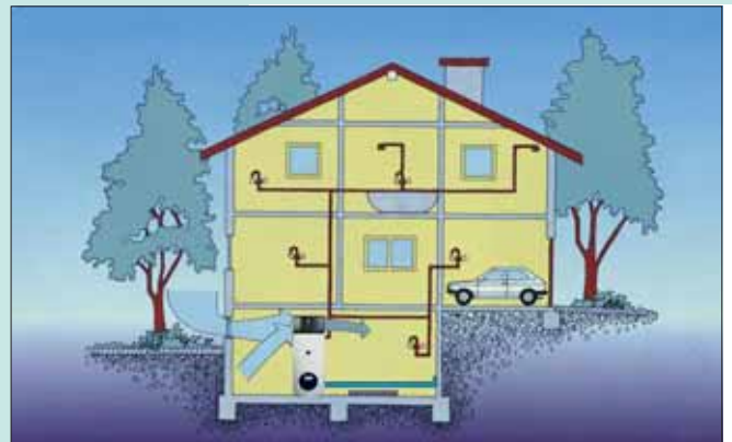
Schema einer Brauchwasser-Wärmepumpe Quelle: Style-System Technik
