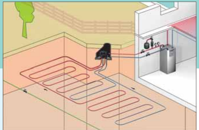
Schema Erdwärmekollektoranlage Quelle: Vaillant
