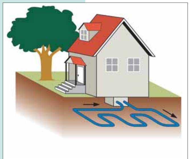
Schema einer Erdwärmekollektoranlage Quelle: Geologischer Dienst NRW
