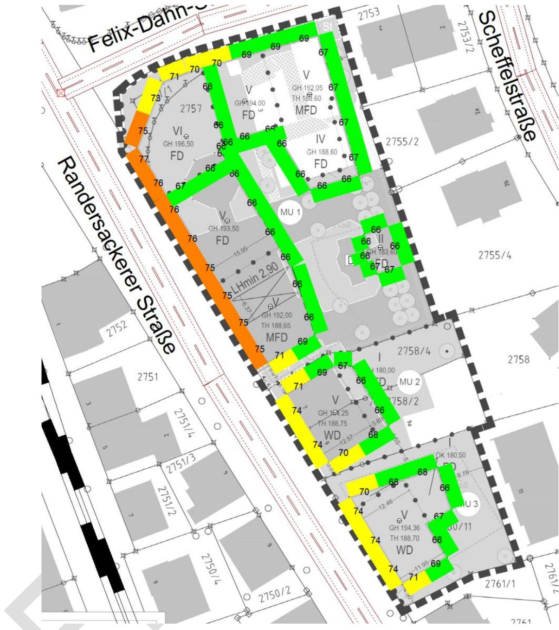
Abb. 1: Schallschutzmaßnahmen SM 1: Schallschutz gegen Außenlärm für schutzbedürftige Räume von Wohnungen, Übernachtungsräume in Beherbergungsbetrieben, Bettenräume in Krankenhäusern und Pflegeeinrichtungen sowie vergleichbar schutzbedürftige Räume, maßgebliche Außenlärmpegel nach DIN 4109-2:2018-01
