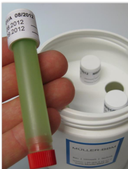
Abbildung 5. NO 2 -Passivsammler mit Witterungsschutzgehäuse (Nahaufnahme).
