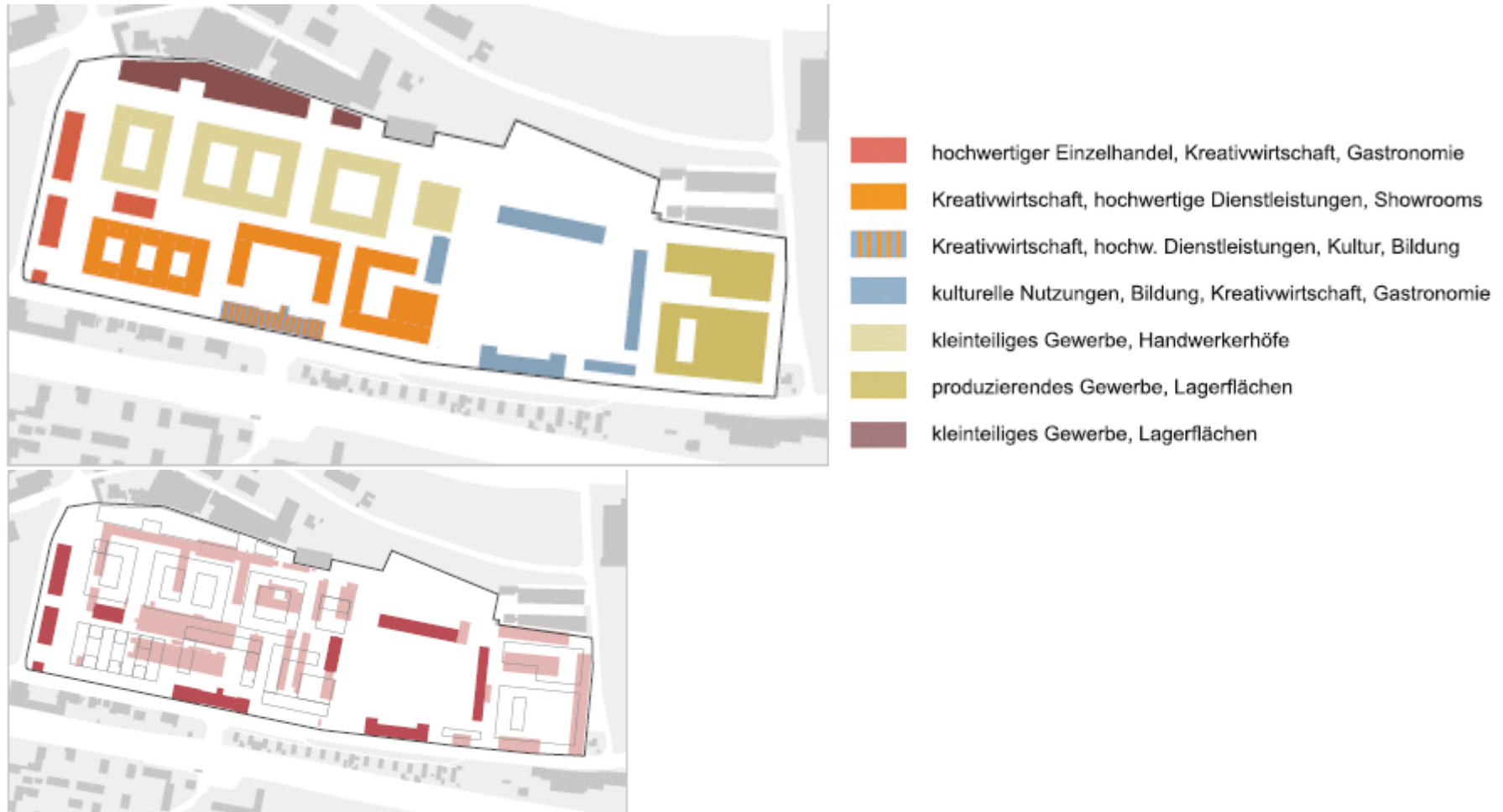
Überlagerung bestehende / geplante Baustruktur (Baudenkmäler in dunkelrot)
